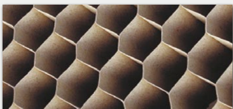
(A) Wkład stabilizujący „plaster miodu”
