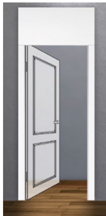
4. Ościeżnica regulowana z panelem górnym podwyższonym od 261 mm do 1000 mm Listwa opaskowa 60/20 lub 80/20
