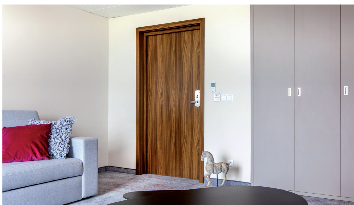
drzwi EI60 PLUS, ościeżnica drewniana regulowana
