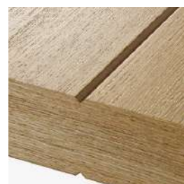
zbliżenie na frezowanie - widoczna struktura podłoża
